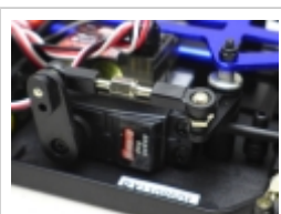
Servomotor 6 kg přes táhla ovládá zatáčení předních kol. Zdroj: www.himoto.cz
