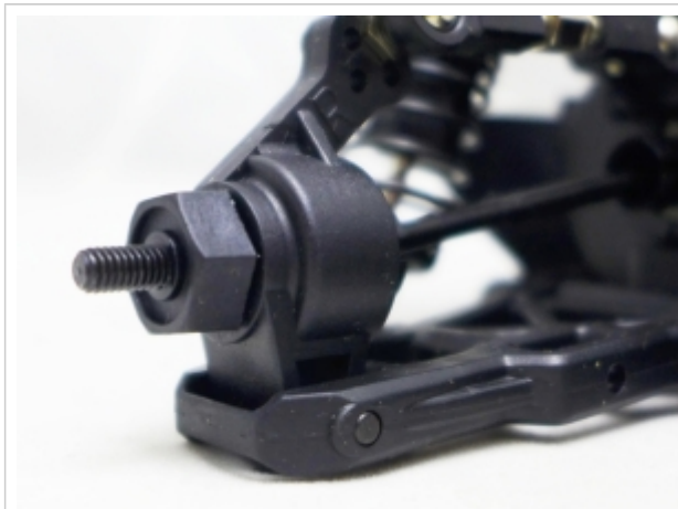
Ložisko kola uzavřené v krytu. Zdroj: www.himoto.cz
