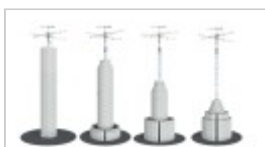
Obrázek 4 Princip ukládání energie u betonové věže EnergyVault®
